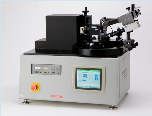
仪器可以创建三维图形，可以通过对试样的一次测量，显示磨损频率，正向载荷，摩擦力/磨损力之间的关系。
